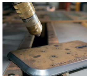
Découpe chanfrein avec tête 3D 3D chamfering cutting 3D Anfasenschnitt
