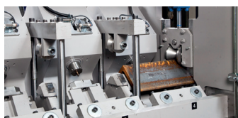
VP-X 166 avec unités monobloc indépendantes VP-X 166 with separate one-piece punching units - VP-X 166 mit getrennten einteiligen Stanzeinheiten
