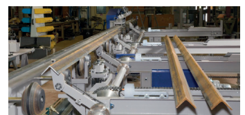
Chaînes de chargement avec bras rotatifs Storage chains and rotating arms Kettenförderer und Dreharme zum Aufladen
