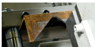
Unité de grugeage avec un angle de 45° Notching unit with 45° angle shape Ausklinkeinheit mit 45° Gehrungsschnitten
