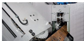
Disque de marquage de grande polyvalence - Highly versatile disc marking unit - Vielseitige Typenrad Markiereinheit
