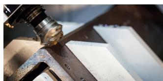
Ecrêtage haute vitesse High speed heel milling Hochgeschwindigkeits-Kantenfräsen
