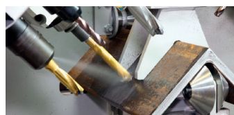
Unités de perçage au-dessus de la cornière : évacuation aisée des copeaux et du lubrifiant - Drill units above the angle: easy collection of chips and coolant - Bohreinheiten über dem Winkelprofil: einfache Späne- und Kühlmittelabfuhr
