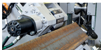
Marqueuse barillet à grande vitesse High speed marking barrel marking unit Hochgeschwindigkeits-Markiereinheit mit Trommel
